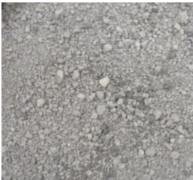
Figura 3 – ASIC: escórias de aciaria.
