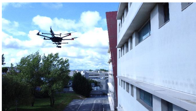
Figura 1 – Veículo aéreo não tripulado utilizado na inspeção remota.
