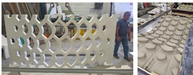
Figura 16 – Produção de um painel pré-fabricado.
