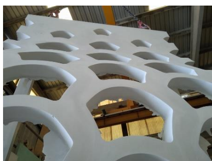
Figura 10 – Produção de um painel para validação dos moldes.
