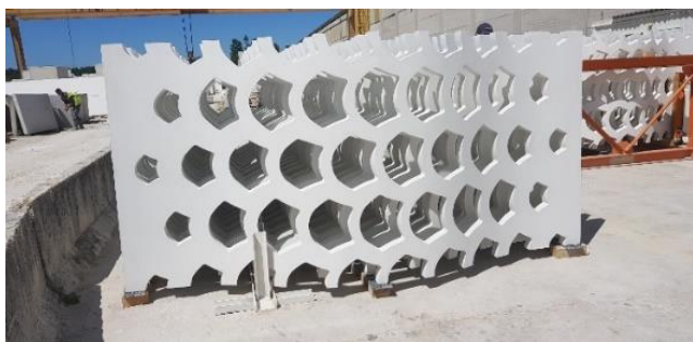
Figura 17 – Armazenamento de painéis pré-fabricados.
