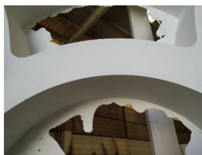
Figura 10 – Produção de um painel para validação dos moldes.
